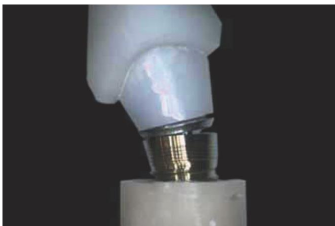
12 Показательный образец, позволяющий продемонстрировать резкое искажение тестового имплантата с абатментом Lava.
